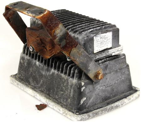
Hrđa se brzo stvara na materijalima koji ne spadaju u marine razred.
